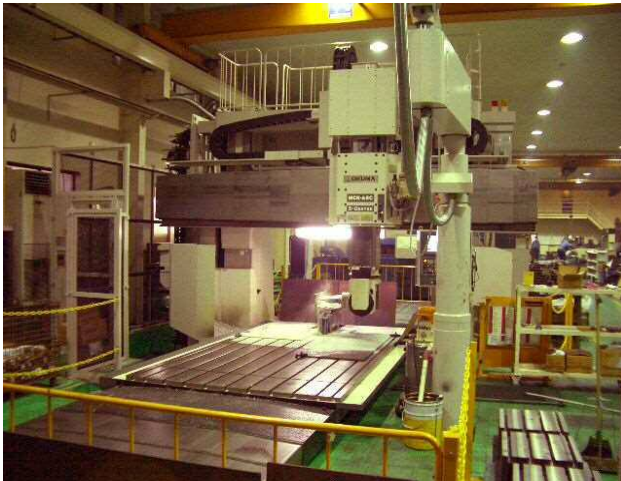
五面加工機 4m×2m×0.65m
