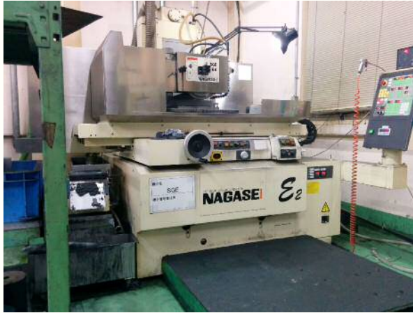
ナガセインテグレックス SGE64SLD ・テーブル寸法 600×400 ・最大研磨寸法 750×445
