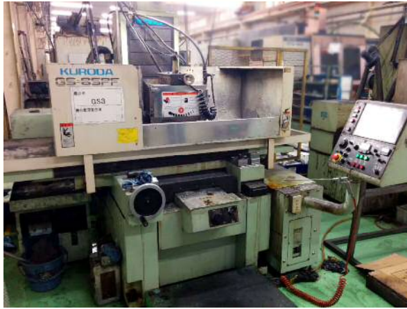
黒田精工 GS65PF ・最大研磨寸法 600×500
