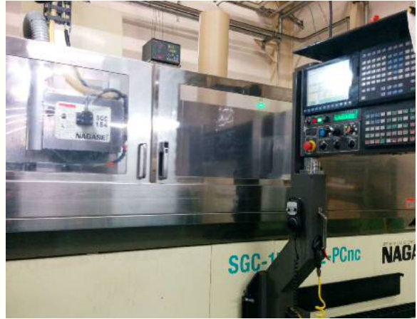
ナガセインテグレックス SGC154SLS2 ・テーブル寸法 1500×400 ・最大研磨寸法 1700×440
