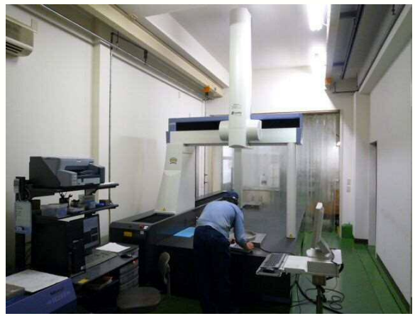
ミツヨ 三次元測定器 ・最大測定寸法 1205×3005×1005
